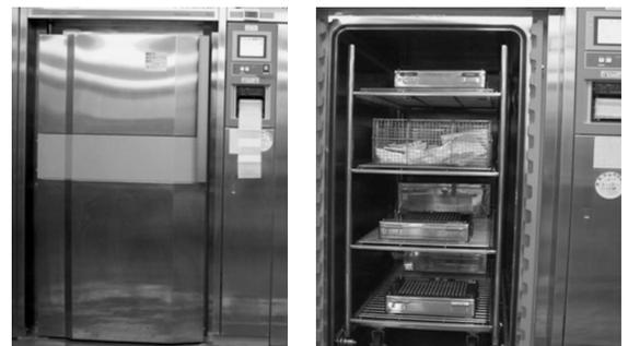
写真3 高圧蒸気滅菌装置とチャンバー内部
