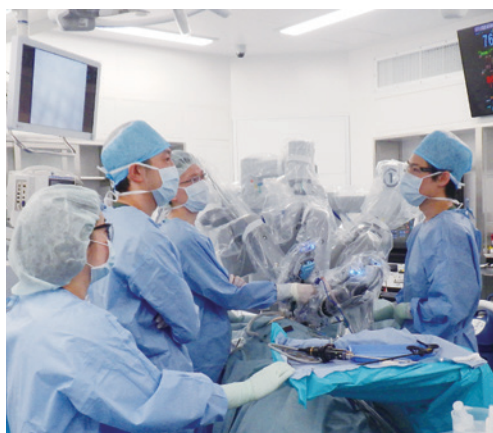
透明なビニールがかかっている器機が患者さん側のユニット（パシエントカート：ダビンチサージカルシステム インテュイティブ社）。写真右が筆者。
