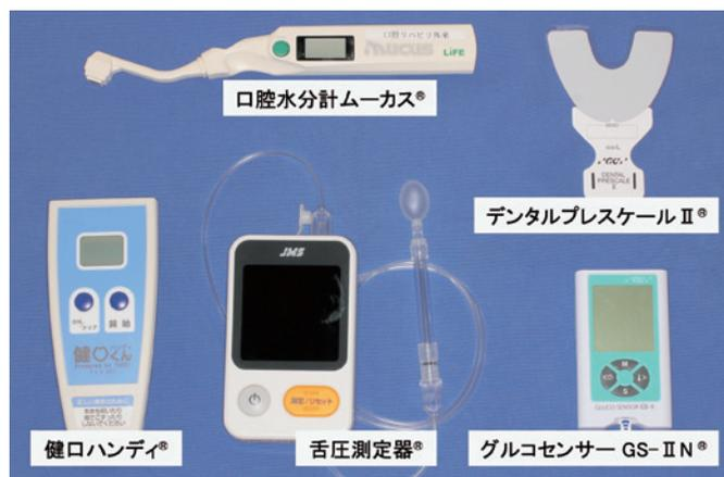
図2 口腔機能精密検査で使用する器具
