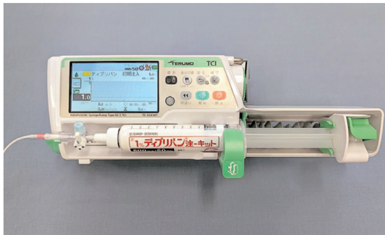
図2 TCI (Target Controlled Infusion) 機能付きシリンジポンプ
