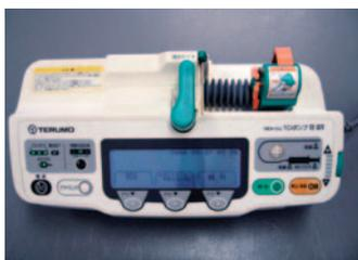
図 コンピューター制御のシリンジポンプ
