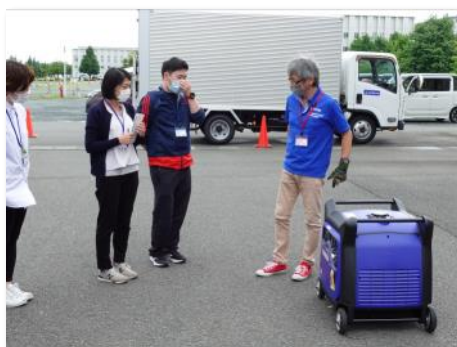
大型の発電機は、セルモーターで起動させるため、操作は比較的簡単
