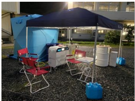
循環式のシャワー 使用済みの水を浄水し循環使用するため、少量の水を有効活用できる
