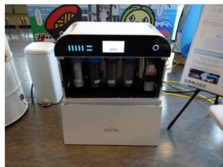
循環型のシャワーの浄水装置部分。使用した水が複数のフィルターを通して浄水される
