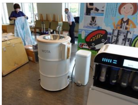
水の追加供給が期待できない場所で、循環型の手洗い装置の有効性は高い
