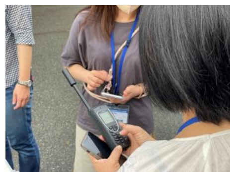
イリジウム Extremeから携帯電話に発信する周回軌道衛星はアンテナを天頂方向に向ける
